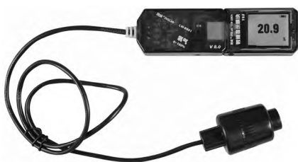
图 1 使用氧气传感器测量空气中的氧气含量
